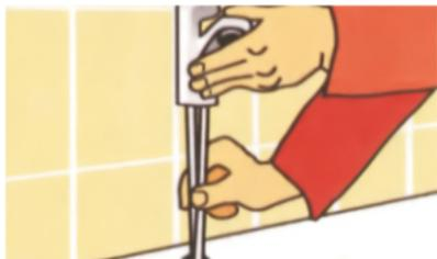
Вставить сверху смеситель и прикрутить снизу. Не забудьте прокладки. В некоторых случаях рекомендуется установить смеситель до установки умывальника.
