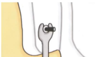
Отсоединить винты для крепления, снять умывальник. Демонтировать старый крепежный материал, если будет другое расстояние между креплениями или другая высота.
