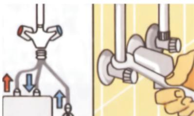
Вставить гибкий шланг в угловой вентиль и завинтить накидную гайку. Для подсоединения электрического бойлера вам необходим аккумулятор низкого давления с тремя соединениями.
