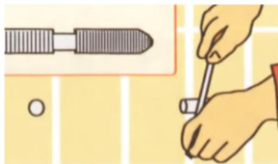
Ввинтить в стену новый подвесной болт с помощью гаечного или газового ключа.
