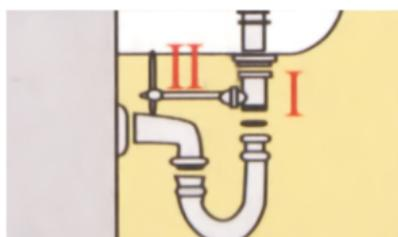
Установить отводную арматуру и спускной вентиль. Отверстие сифона размещать по направлению к стене. Отрегулировать сифон.
