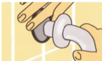
Вставить металлическую сливную трубу, для герметизации использовать резиновую муфту.
