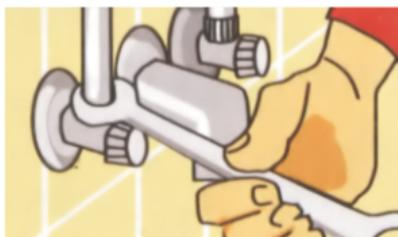
Отсоединить крепления угловых клапанов, демонтировать смеситель.
