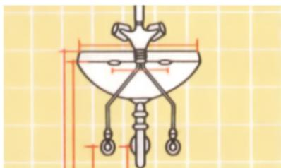
Перед покупкой измерить умывальник: общую ширину, расстояние между креплениями, расстояние от места слива и подвода воды, расстояние от пола до верхнего края.
