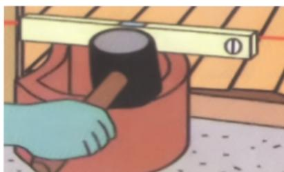
Первую кадку установить углублением в сторону начала ряда. С помощью резинового молотка забить кадку в бетон и выровнять.
