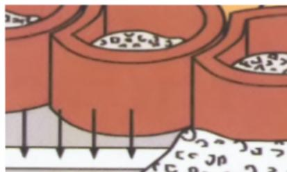
Первый ряд на одну треть заполнить гравием. Дополнительно можно предусмотреть желоб для водопроводов в качестве защиты от замерзания, чтобы избежать застоя воды в засыпанной обратно земле.
