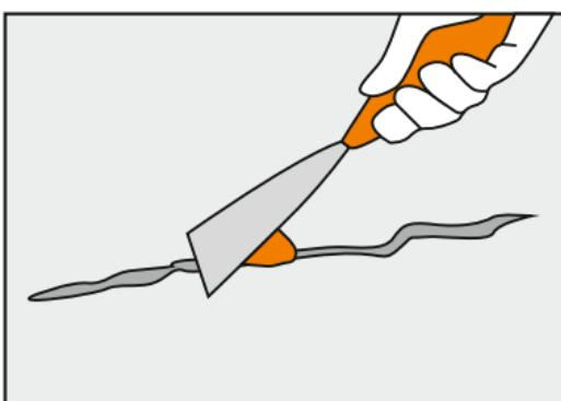
Заполните трещины тонким слоем строительного раствора с добавлением смолы или клеевым раствором.
