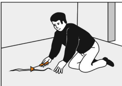
Соскоблите хрупкое содержимое трещин (цемент и т.д.) с помощью треугольного скребка. Тщательно очистите места соединения между плитками или досками пола.
