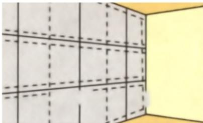
ГКЛ первого ряда на второй стороне стены должны быть в 2 раза уже. Смещение стыков повышает жесткость перегородки.
