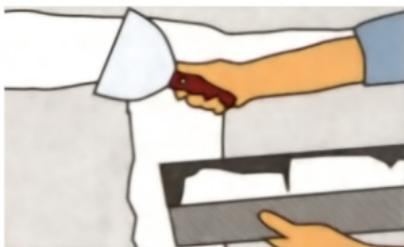
Места стыков, примыкания и головки шурупов заделать шпаклевкой для швов. После высыхания отшлифовать шпаклевку наждачкой.
