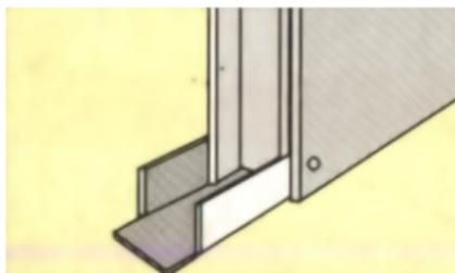
Вместо показанного на рисунке металлического каркаса можно изготовить несущую конструкцию из деревянных брусьев.
