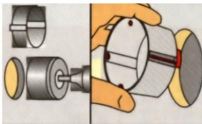
Отверстия для розеток и выключателей вырезать фрезой-насадкой до установки плит. Установить на распорки розеточные коробки.
