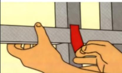
Для дверей в качестве перемычки используется специальный ПН профиль (профиль жесткости), закрепляемый к смонтированным стойкам.
