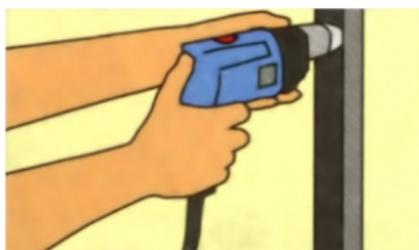
Вертикальные направляющие ПН вставляются в горизонтальные профили сверху и снизу, затем крепятся к стене (расстояние между креплениями 50 см).
