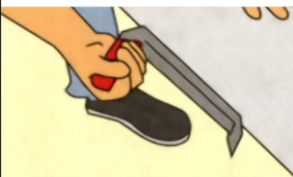
Обработать кромки рубанком - под прямым углом или уклоном. На верхней кромке срезать фаску - для заделки стыков раствором.
