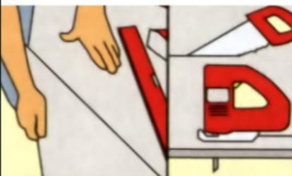
Резка гипсокартонных плит (минимальная толщина = 12,5 мм): надрезать на лицевой стороне, переломить по краю стола, разрезать картон с обратной стороны. Также можно использовать ножовку или лобзик.
