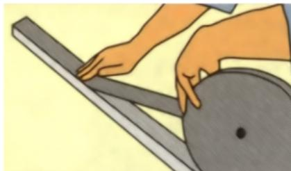
Для улучшения тепло- и звукоизоляции на заднюю сторону напольных, стеновых и потолочных профилей наклеивается изоляционная лента.
