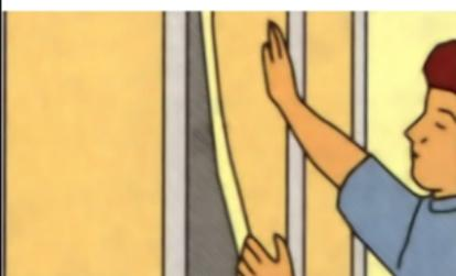
В пространстве между панелями проложить коммуникации. Затем заполнить изоляционными матами (из минераловаты) для звуко- и теплоизоляции.
