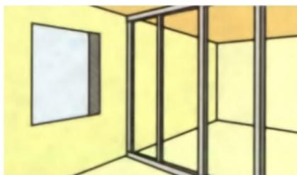
Стоечный вертикальный профиль ПС вставляется сначала в напольный, а затем в потолочный профиль на одинаковом расстоянии, например, 60 см (в зависимости от размера гипсокартона и направления монтажа) и выравниваются по вертикали.
