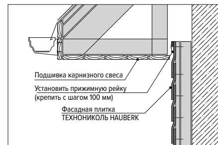
Рис. 9.1. Монтаж верхнего ряда под карнизным свесом
